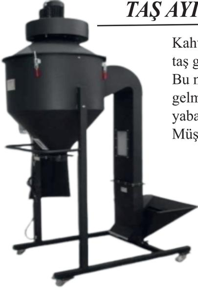
Kahve gibi çeşitli malzemelerin hazır alındığı zamanlarda içerisinde yer alan taş gibi yabancı maddelerin elenmesi, ayrılması gerekmektedir. Bu noktada çok fazla tercih edilen makinelerin başında taş ayırıcı makinesi gelmektedir. Taş ayırıcı makine, boyutları aynı fakat özgül ağırlıkları farklı olan yabancı madde ve taşların ilgili malzemeden ayrılması için kullanılmaktadır. Müşteri isteği doğrultusunda NOVA Serisi makinalara akuple edilebilir.
