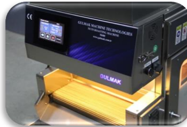
Dokunmatik Kontrol Paneli
