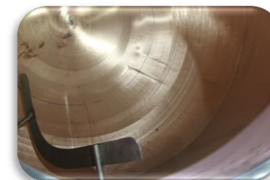
Лопости для размешивания выполнены из нержавеющей стали AISI 304 качества
