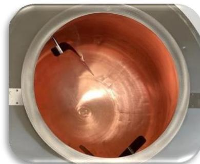
**Гладкий барабан для нанесения покрытия**
