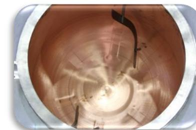
**Гальваническое покрытие медью 4 ММ**
