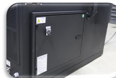
Скрытая электрическая панель
