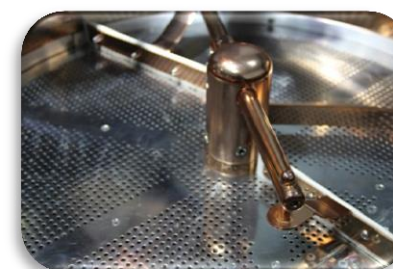
Охлаждающий поддон выполнен из нержавеющей стали AISI 304
