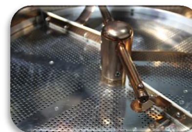
Охлаждающий поддон выполнен из нержавеющей стали AISI 304
