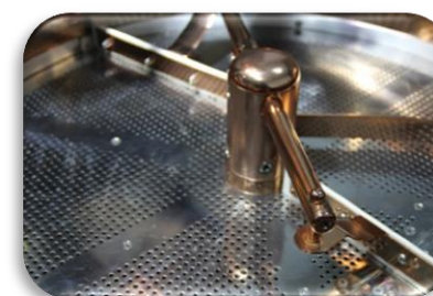
Охлаждающий поддон выполнен из нержавеющей стали AISI 304
