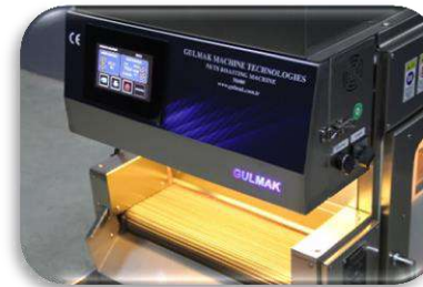
Dokunmatik Kontrol Paneli
