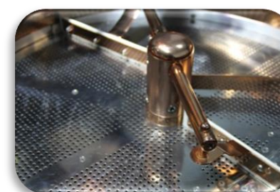
Охлаждающий поддон выполнен из нержавеющей стали AISI 304
