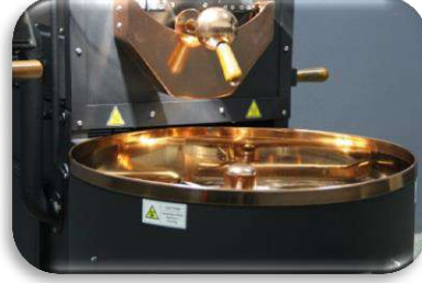
Geniş Hacimli Soğutma Ünitesi
