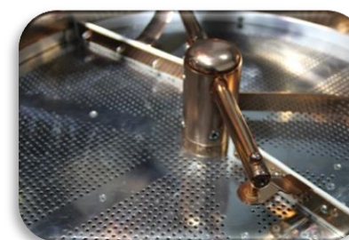
Охлаждающий поддон выполнен из нержавеющей стали AISI 304
