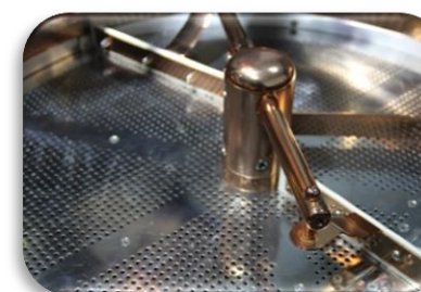
Охлаждающий поддон выполнен из нержавеющей стали AISI 304
