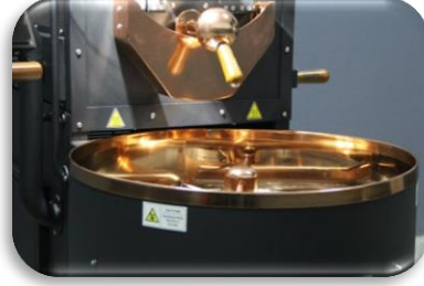
Geniş Hacimli Soğutma Ünitesi
