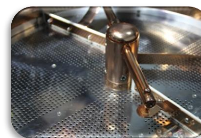
Охлаждающий поддон выполнен из нержавеющей стали AISI 304
